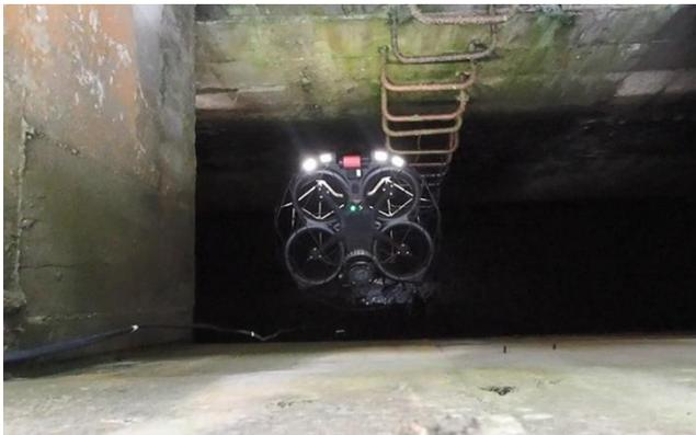
水力発電所の水路内部を点検する ELIOS 3
