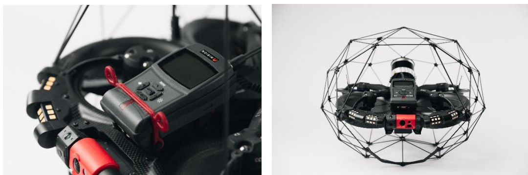
ELIOS 3 RAD パイロードの放射能センサー(左)と取付後の ELIOS 3(右)
