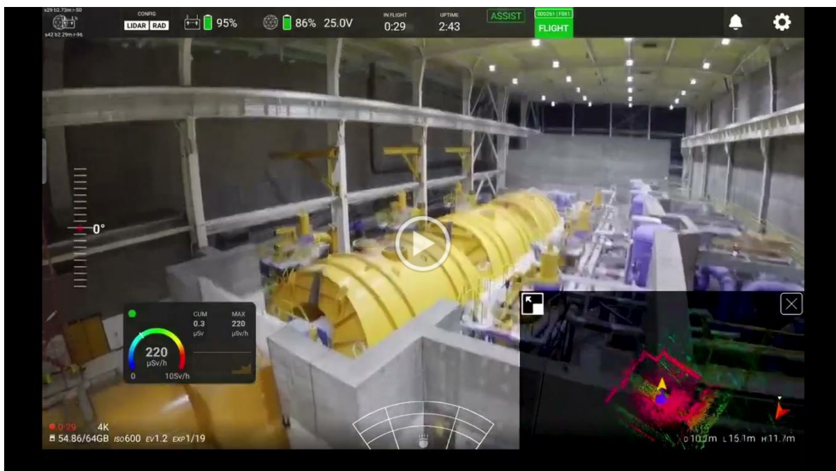
北米で実施された ELIOS 3 RAD ペイロードの飛行テスト映像
