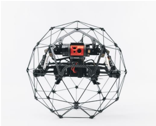
ELIOS 2 RAD 外観(左)と、搭載されている放射線センサー(右)
