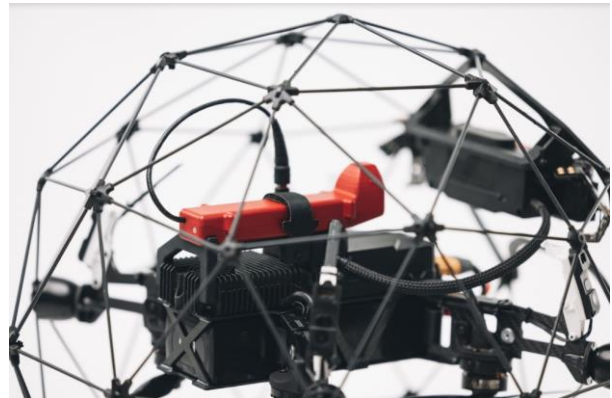
ELIOS 2 RAD 外観(左)と、搭載されている放射線センサー(右)
