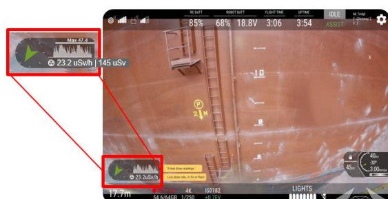
飛行中の線量と空間線量示度、累積線量などをリアルタイムに表示
