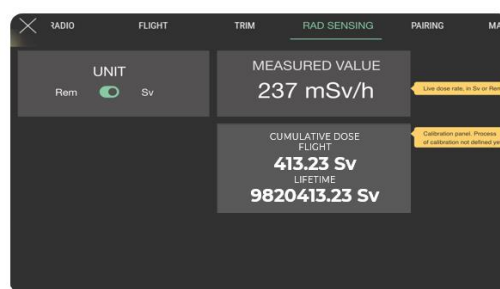
飛行中の線量と空間線量示度、累積線量などをリアルタイムに表示
