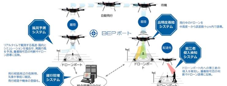
(図-5) ドローンポート・システム<sup>9)</sup>
