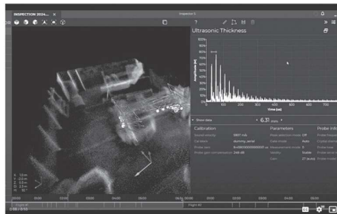
図11 バラストタンク内のUT検査
