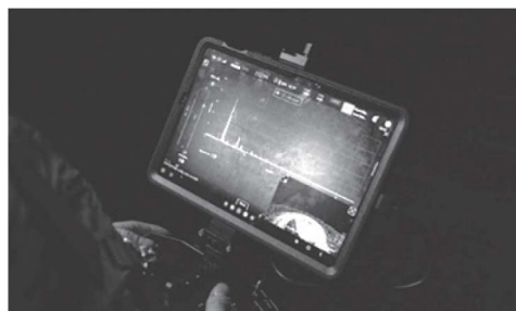
図12 煙突内部のUT 検査
